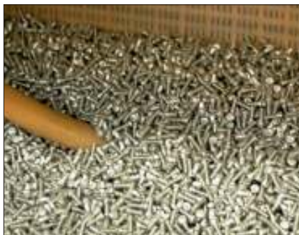
Schrauben, giftfrei und zuverlässig gegen Korrosion geschützt, verlassen die Trommelverzinkungsanlage.
