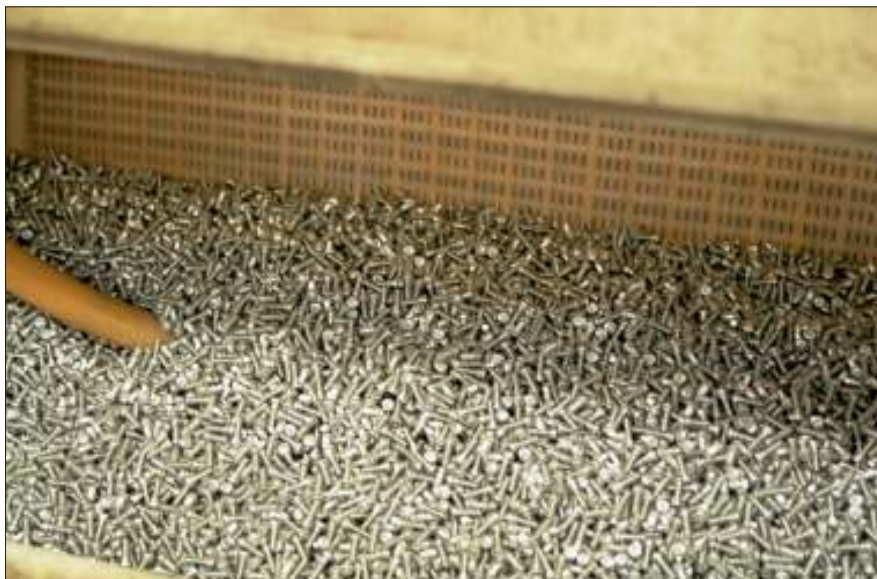
Schrauben, giftfrei und zuverlässig gegen Korrosion geschützt, verlassen die Trommelverzinkungsanlage.
